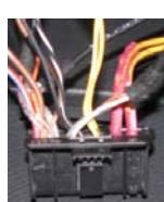
Шина CAN представляет собой витую пару, состоящую из проводов CAN-H и CAN-L.
